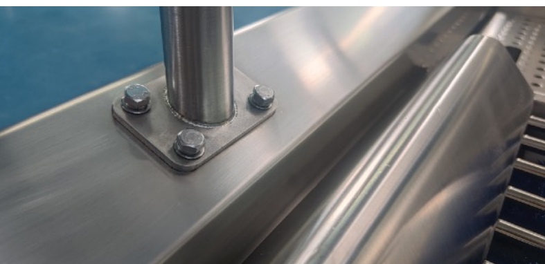
Съемные рейлинги для рук при установке в узкие проходы
