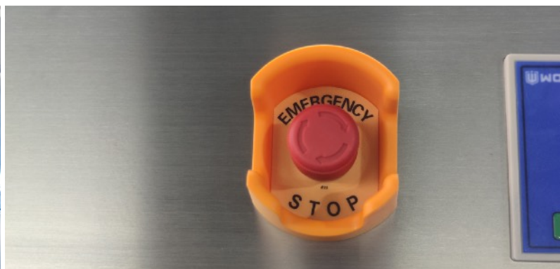
Аварийный выключатель в защитном корпусе на фронтальной панели
