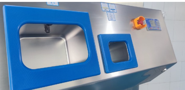
Накладки из кислотостойкого пластика для безопасного погружения рук
